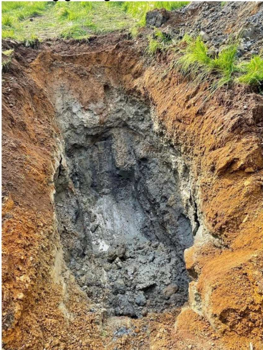
Figur 8: Gravepunkt 3 i Breivik. Matjord over faste masser med høyt finstoffinnhold.
