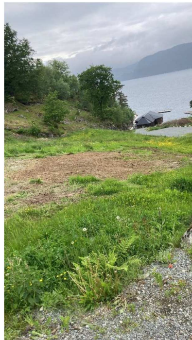
Figur 8: Gravepunkt 3 i Breivik. Matjord over faste masser med høyt finstoffinnhold.
