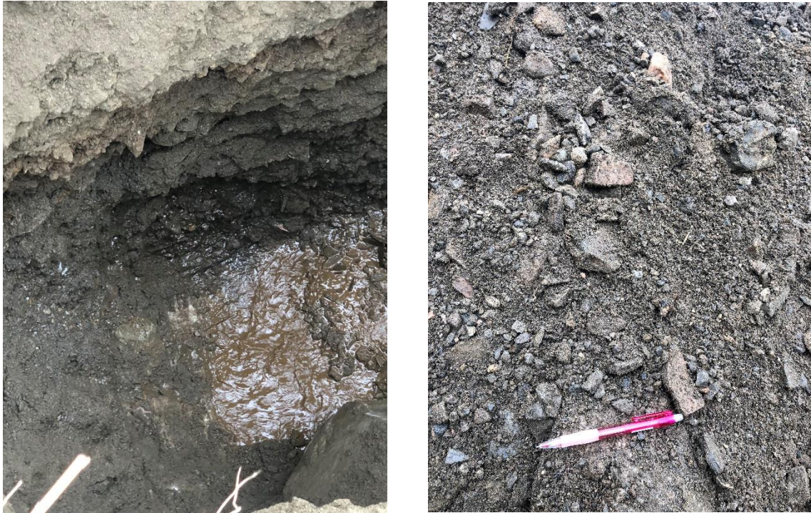
Figur 6: Gravepunkt 1. Masser av sandig, grusig materiale med enkelte stein. Grunnvannstand på ca. dybde 3,5 m under terreng.
